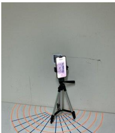
ภาพที่ ก-2 แสดงการทดลองสแกน Dual Image QR Code มุมมองด้านขวา
