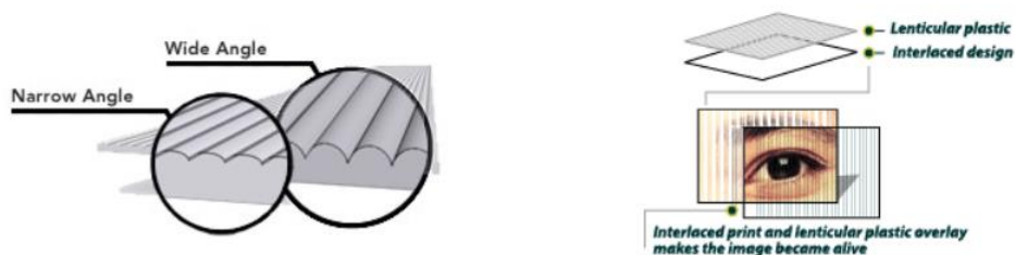
ภาพที่ 2-32 แสดงตัวอย่างของ Lenticular Lenses (Lenstar Lenticular, 2008)
